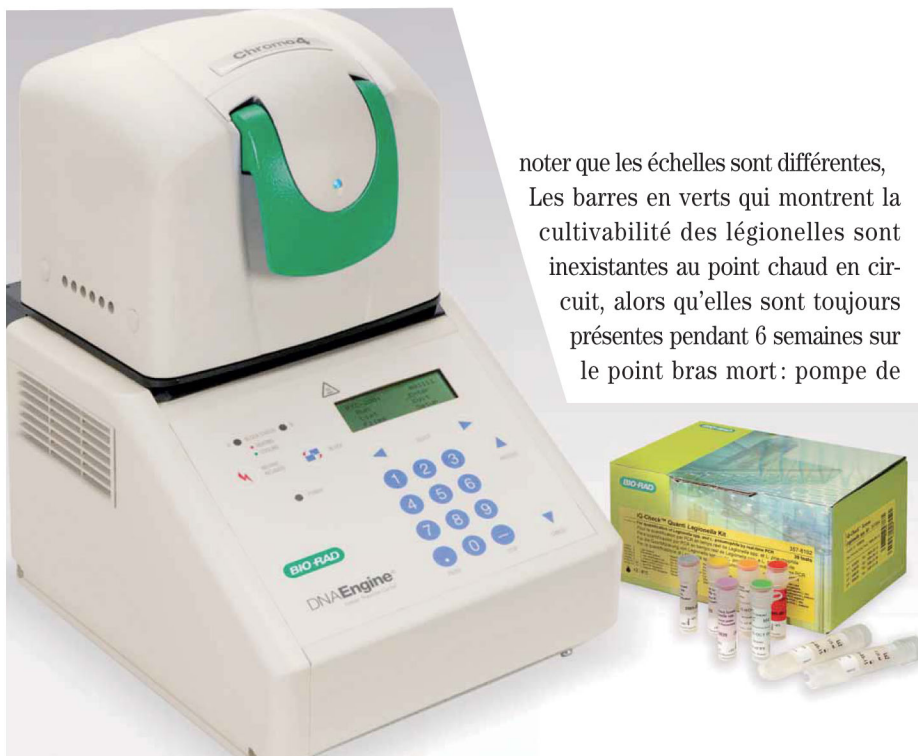
Kits IQ-Check Legionella™ correspondant aux exigences de la norme Afnor XP T 90- 471 pour la détection et la quantification des légionelles dans l'eau, l'air et les biofilms.
