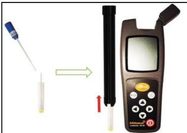
Casser le bâtonnet au niveau du point de rupture en maintenant l'écouvillon dans le tube.
