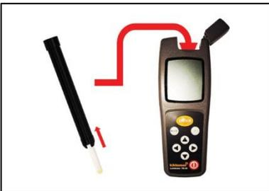
Fixer le tube au porte-tube compatible PD30.
