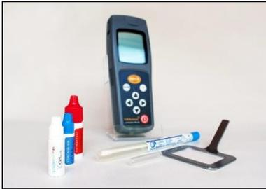
Décongeler un flacon de chaque réactif (**DENDRIDIAG® BF**, **EXTRACTANT** et **STANDARD 1000**). Laisser les revenir à température ambiante (supérieure à 18°C).
