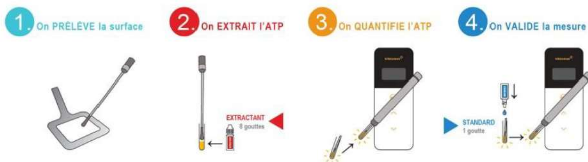
Figure 1 : Mode opératoire d'analyse de surface par ATP-métrie quantitative (source : GLBiocontrol)
