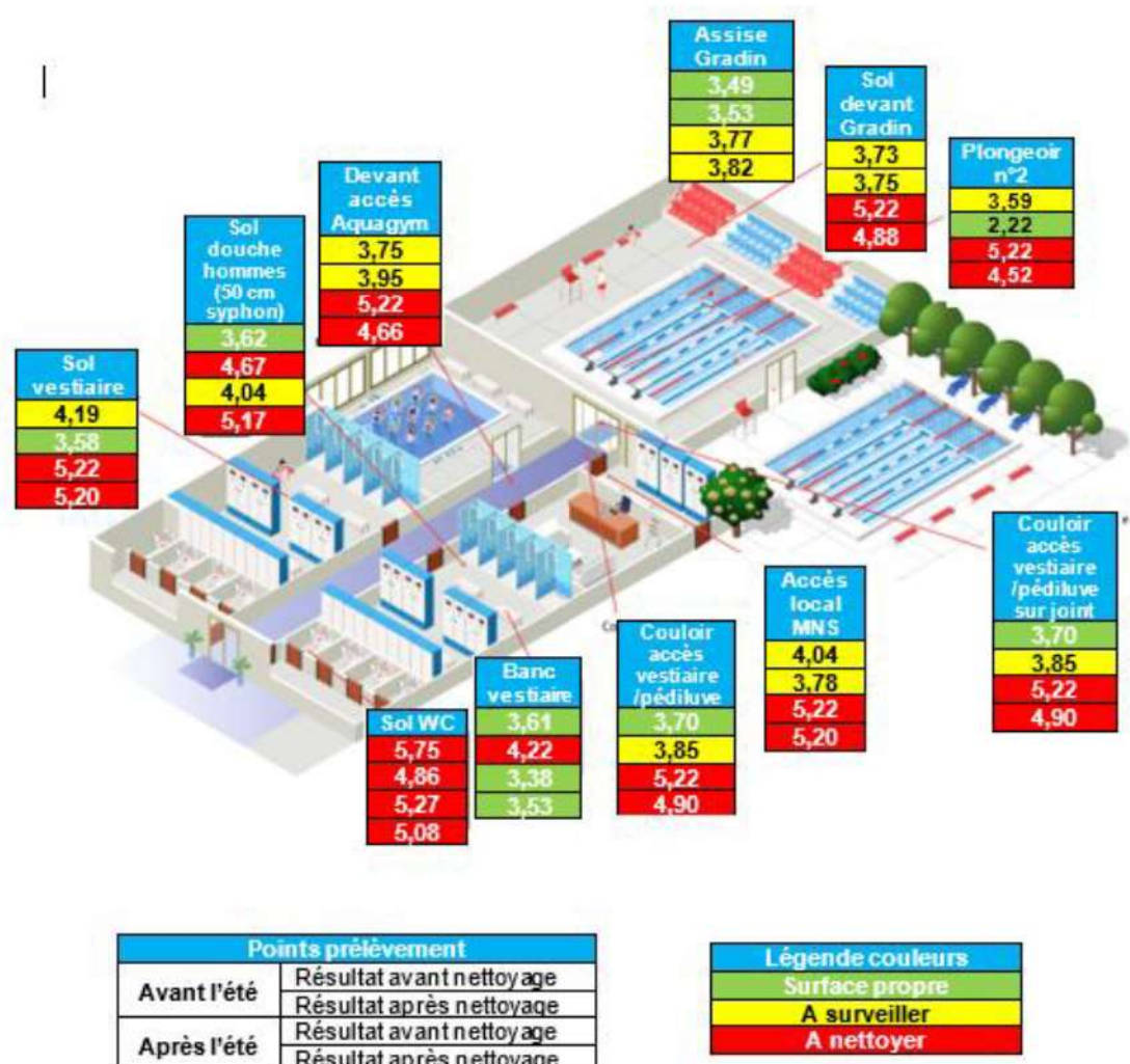
Figure 3 : Exemple d'usage 1 : L'usage de l'ATP métrie en constat d'exploitation. Cartographies réalisées avant l'été puis après la période estivale. Dans ces deux cas des mesures ont été réalisées avant puis après nettoyage.
