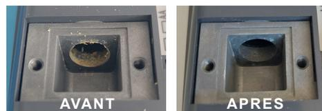
Exemple d'un nettoyage d'une chambre de mesure encrassée
